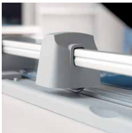
Uzavřená hlava nože pro bezpečnou obsluhu řezačky
